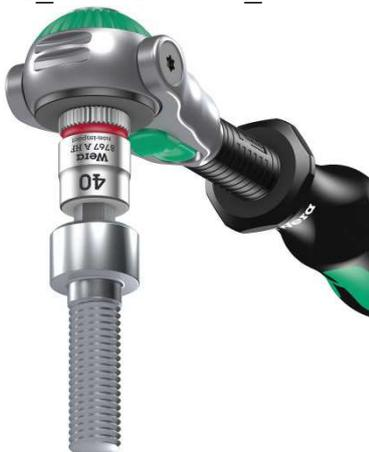
Sur les douilles à embout Hex-Plus (6 pans) c'est un mécanisme à bille qui assure la fonction de retenue et permet un retrait facile de l'outil en fin d'opération de vissage.
